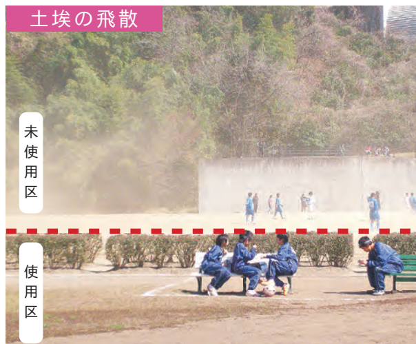
河辺市民球場 (東京都青梅市) 撮影日: 平成 23 年 4 月 面積: 4,010m 2 JGS-CCクレイ未使用区 (破線上部) は土埃がたっているが、JGS-CCクレイ使用区 (破線下部) は全くたっていない。
