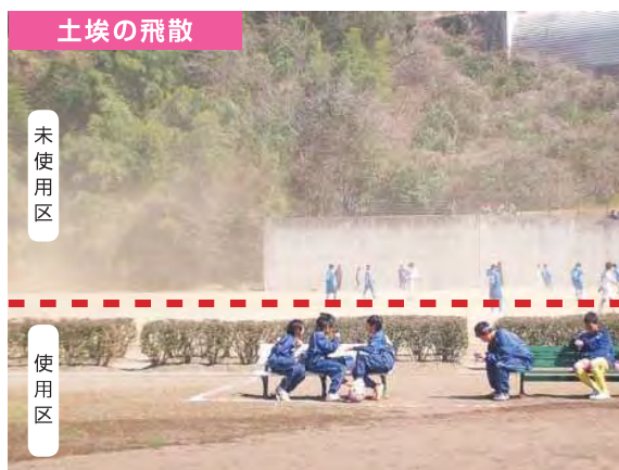
河辺市民球場 (東京都青梅市河辺町) 撮影日: 平成23年4月 面積: 4,010m 2 JGS-CC ® クレイ未使用区 (破線上部) は土埃がたっているが、JGS-CC ® クレイ使用区 (破線下部) は全くたっていない。
