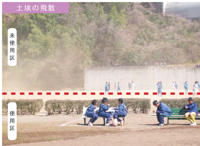
河辺市民球場（東京都青梅市） 撮影日：平成23年4月 面積：4,010m 2 JGS-CCクレイ未使用区(破線上部)は土埃がたっているが、 JGS-CCクレイ使用区(破線下部)は全くたっていない。
