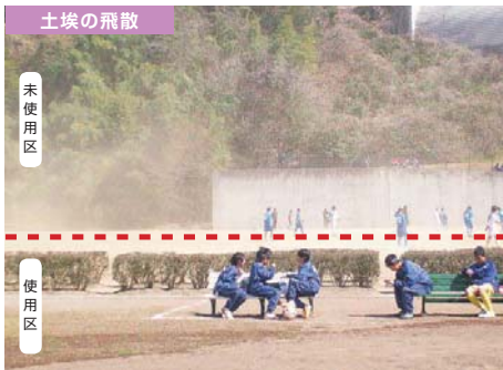
河辺市民球場 (東京都青梅市河辺町) 撮影日:平成23年4月 面積:4,010m 2 JGS-CC ® クレイ未使用区(破線上部)は土埃がたっているが、 JGS-CC ® クレイ使用区(破線下部)は全くたっていない。
