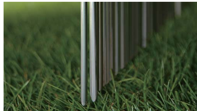
ハイブリッド芝の一体型専用マシンで天然芝の上から人工芝繊維を打ち込む様子(ベルギー デッソスポーツ社)【写真提供:株式会社バルカ】
