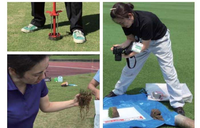
試験施工による効果確認(ホールカッターを利用し芝生の根を確認)
