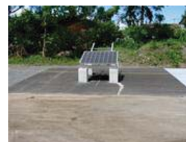
アスファルト舗装区
